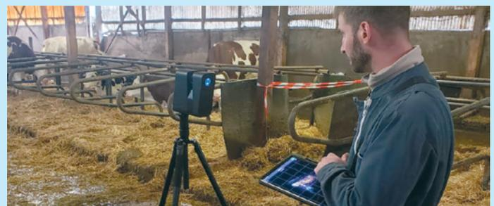
*Scan 3D du bâtiment en amont de l'installation des caméras pour optimiser leurs positionnements*
